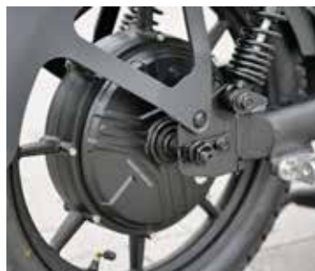
De 1.000 Watt naafmotor doet goed zijn best
